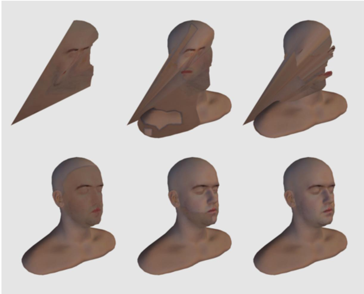
Abbildung 7.9: Progressive Streaming mit dem Interlace-Modus des PNG Formates am Beispiel des Modells von Lee Perry Smith von rechts oben bis links unten mit den Zwischenstufen 14 kB, 26 kB, 30 kB, 42 kB, 58 kB und 72 kB. Da die Bilder zeilenweise aufgebaut werden, wird dem Modell stückweise Informationen hinzugefügt, bis dieses komplett sichtbar ist. ©Modell, Lee Perry Smith
