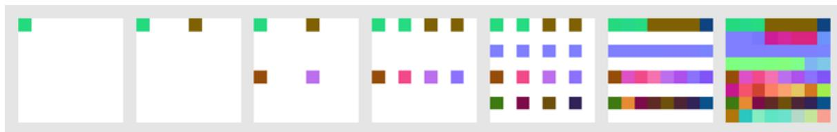
Abbildung 7.4: Die Pixel werden für jeden Schritt nach dem Muster aus Listing 7.2 eingefügt. Bei der Darstellung der Stufe wird zwischen diesen Pixelwerten interpoliert, anstatt lediglich die eingefügten Pixel darzustellen.
