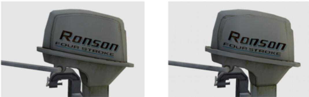
Abbildung 7.13: Artefakte bei der Quantisierung der Texturkoordinaten am Beispiel eines Motorenmodells aus dem CryENGINE 3 Free SDK. Links ist das Ursprungsmodell abgebildet, rechts die mit Image Geometry auf 8 bit quantisierte Version. Es sind deutliche Artefakte an den Rändern der Texturcoordinate zu erkennen. ©Modell, Crytek GmbH
