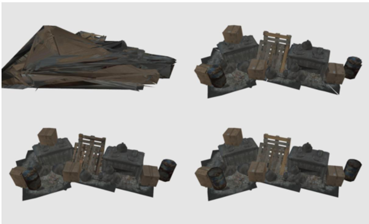
Abbildung 7.1: Links oben wurden für den Index und die Attribute das JPEG Format mit 100% als Qualitätseinstellung in einer Auflösung von  $256 \times 256$  Pixel verwendet. Die verlustbehaftete Kompression des Index-Bildes führt dazu, dass die falschen Dreiecke miteinander verbunden werden.
